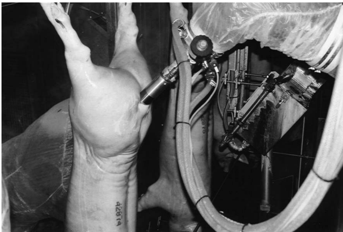
Abb. 2. Industrie-Roboter mit „Rektum-Freischneider“ (Fa. Banns, Biedenkopf) Slika 2. Industrijski robot za opsecanje rektuma (Fa. Banns, Biedenkopf)
