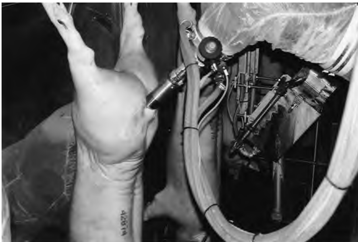
Abb. 2. Industrie-Roboter mit „Rektum-Freischneider“ (Fa. Banss, Biedenkopf) Slika 2. Industrijski robot za opsecanje rektuma (Fa. Banss, Biedenkopf)
