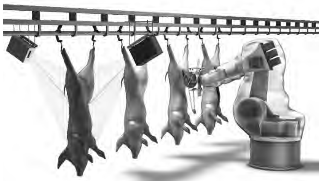
Abb. 1. Laserscanner und Industrie-Roboter mit „Bauch- und Brustbeinöffner“ (Fa. Banss, Biedenkopf) Slika 1. Laserski skener i industrijski robot za rasecanje grudno-trbušnog dela (Fa. Banss, Biedenkopf)
